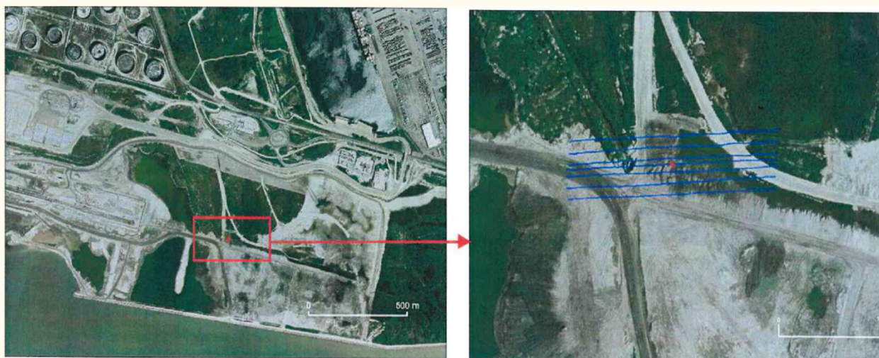
Figure 1 : a) Vue générale du site de mesure sur le port du Havre (2003). Le point rouge est l'emplacement du sondage C1. b) Vue de la zone d'étude et emplacement des profils GPS des mesures EM31 et EM34 (précision au GPS différentiel +/- 50 cm).
